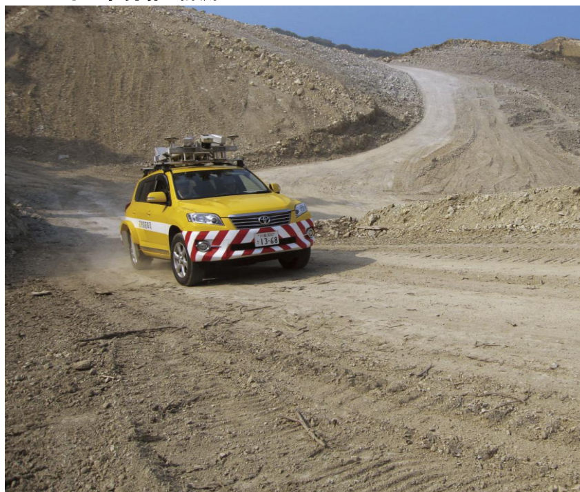
【図1】 MMSによる工事現場の計測
